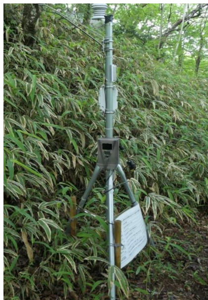
図5 気象観測装置に設置した自動撮影カメラの様子
